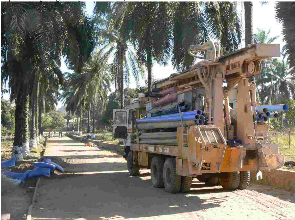
Spezialfahrzeug für die Bohrung des Brunnens auf dem Gelände von NURU
